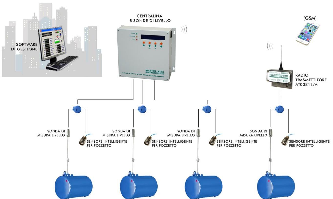
Centralina di misura livelli e monitoraggio allarmi perdite su serbatoi, tubazioni e pozzetti. Gestione di 8 sonde di livello, 16 sensori intelligenti, 4/8 ingressi on/off, fino a 8 relè con uscite ad eventi programmabili. Può essere collegata ad altre 4 apparecchiature per estendere la gestione di livelli, allarmi e relè ed essere interfacciata con i principali sistemi gestionali presenti sulle stazioni di erogazione carburanti.
